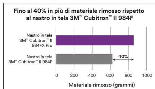
Risultati basati su un test di molatura automatizzato della durata di 10 minuti su acciaio inox 304 utilizzando nastri lunghi 36". Per totale materiale rimosso si intende il materiale totale rimosso in grammi dopo 40 cicli.
