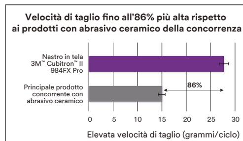
Risultati basati su un test di molatura automatizzato della durata di 10 minuti su acciaio inox 304 utilizzando nastri lunghi 36". Barre di errore = intervallo di confidenza del 95%. Velocità di taglio: materiale totale rimosso in grammi dopo 10 cicli meno il materiale totale rimosso in grammi dopo 3 cicli diviso per 7 cicli. L'unità è espressa in grammi per ciclo.
